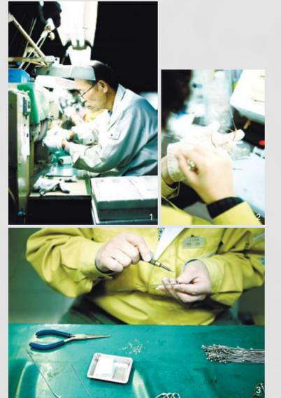
1 竹内光学では、70近いお歳の職人がめがねを高速回転するパワに当てて熟々と研磨している。熟練の職人にしかできない技術も多いという。2 わずかな誤差が命取りになるめがね。三工光学でも検品作業が念入りに行われる。3 三工光学の工場。最大300もの工程を経て作られるめがねは部品の数も膨大。手作業のプロセスも多い
